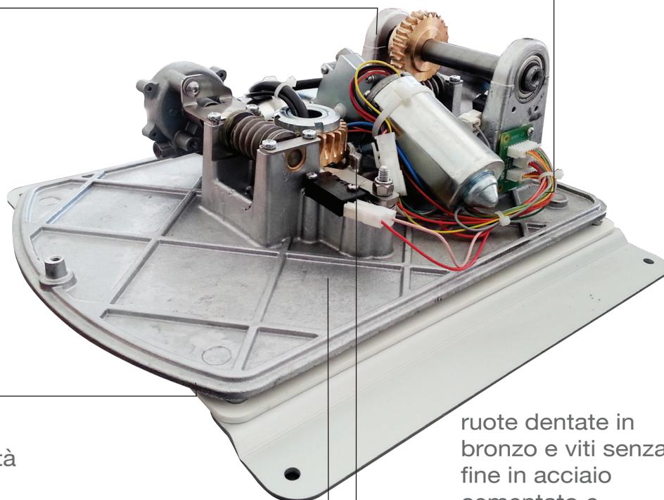
ruote dentate in bronzo e viti senza fine in acciaio cementato e temprato realizzate con accoppiamenti molto precisi, per garantire una ottima stabilità al vento e un uso prolungato senza manutenzione.
